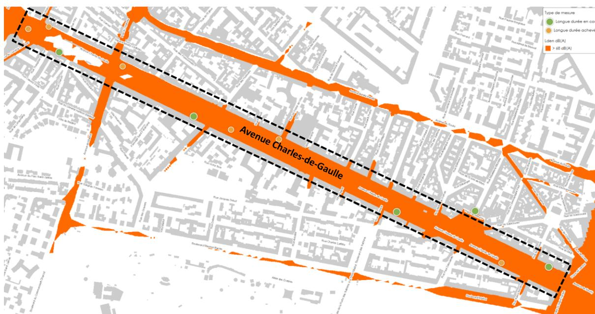
Figure 3 : Dépassement du seuil de 68 dB(A) pour le bruit routier - Indicateur Lden (source : Bruitparif).
